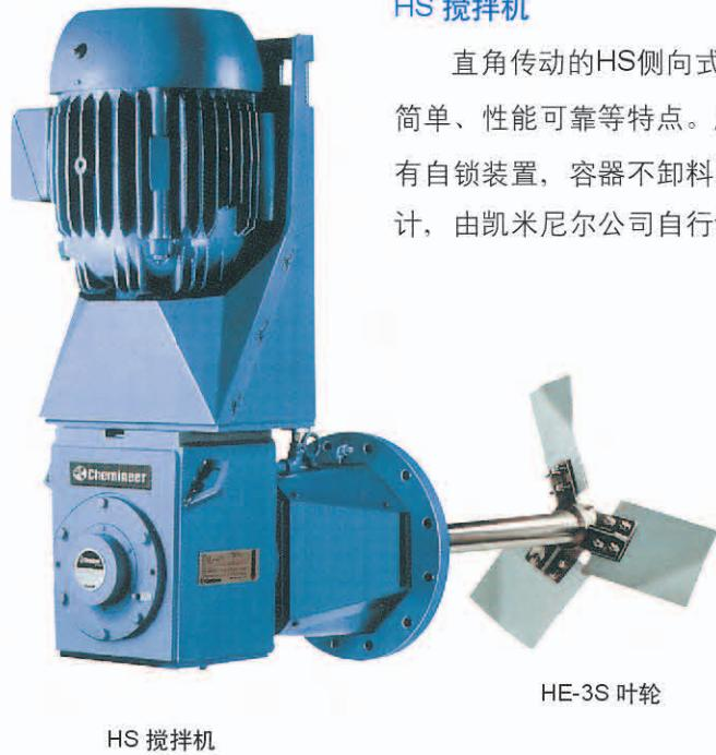
直角传动的HS侧向式搅拌机采用精密加工的螺旋伞齿轮组，具有结构坚固、设计简单、性能可靠等特点。所有HS搅拌机的密封使用寿命长而维护简便，密封结构均配有自锁装置，容器不卸料即可更换密封。HS齿轮传动装置专为侧向式搅拌机应用而设计，由凯米尼尔公司自行设计和加工。
