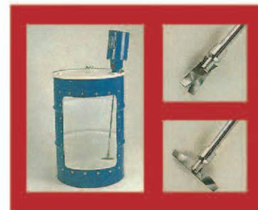
标准10XP型搅拌机，采用折叠式推进器，用于2"开口的油桶上
